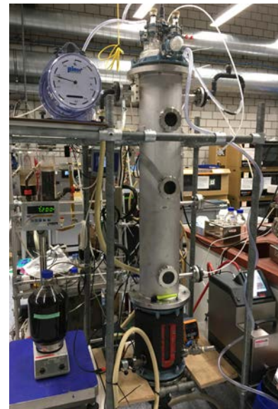
Dans ce fermenteur d'une capacité de 60 l, l'eau de traitement a été fermentée et le carbone qu'elle contenait a été transformé en biométhane.
