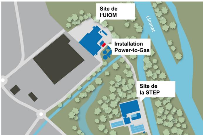
L'installation PtG de Dietikon utilise le gaz d'épuration (biogaz brut) de la STEP voisine et l'électricité de l'UIOM. Illustration : rapport final de l'OFEN
