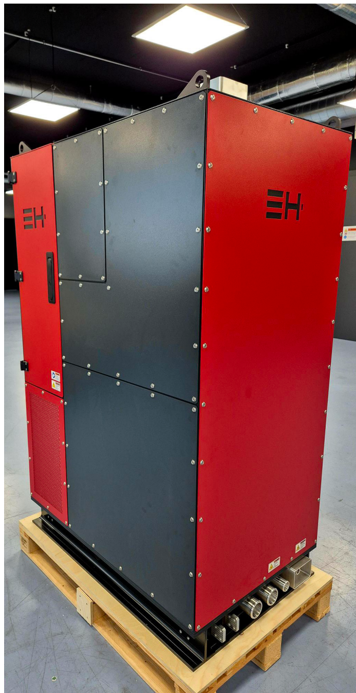
Système de piles à combustible du EH Group d'une puissance de 250 kilowatts (prototype). L'appareil récemment conçu dispose d'environ 120 capteurs et actionneurs, dont des capteurs de pression, de température et d'humidité, qui servent à contrôler tous les composants du système en toute sécurité. Photo: EH Group
