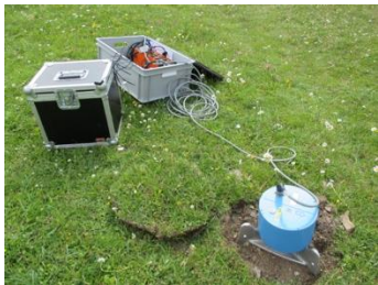
Mesure H/V à la station STSW2(Tseuzier, VS)
