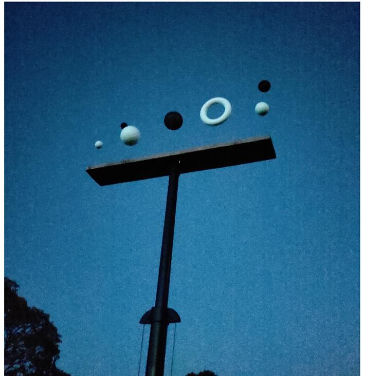
Installation d'essai qui a permis de vérifier si des objets pouvaient être détectés par rayonnement infrarouge en fonction de leur taille, de leur forme et de leur couleur. Photo : rapport final AMM-FAUNA
