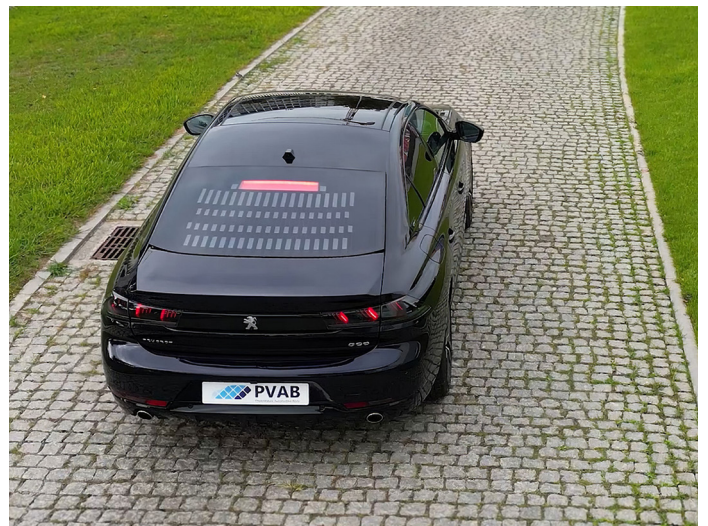
Sur cette Peugeot 508, la lunette arrière a été remplacée par un module en plastique doté de cellules photovoltaïques. Photo de: Julien Robin, et al. « PhotoVoltaic Automotive Body (PVAB) Project Outcome of 3 years of VIPV R&D industrial project » in PVinMotion2024, 6-8 March 2024 in Neuchatel
