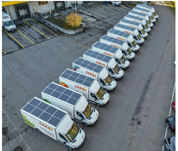
Les véhicules de livraison de COOP sont aujourd'hui déjà partiellement équipés de toits solaires. Jusqu'à présent, l'énergie solaire était utilisée pour alimenter les batteries des groupes frigorifiques et pour garantir l'alimentation permanente des unités télématiques. Photo: David Lambelet
