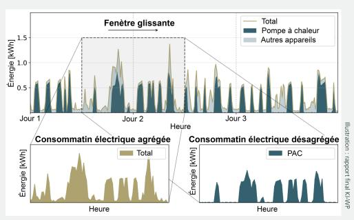
mettant d'isoler (de « désagréger », dans le jargon scientifique) certains gros appareils électriques de la consommation totale. Dans le cas des pompes à chaleur, cette méthode fonctionne avec une grande fiabilité en intégrant les données de température. Au final, on sait donc pendant quelle période la pompe à chaleur a fonctionné et quelle quantité d'électricité elle a consommée.
