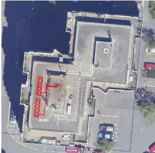
Figure 9: Plan de toiture avec proposition d'implantation des PAC – Mon-Idee 51-53
