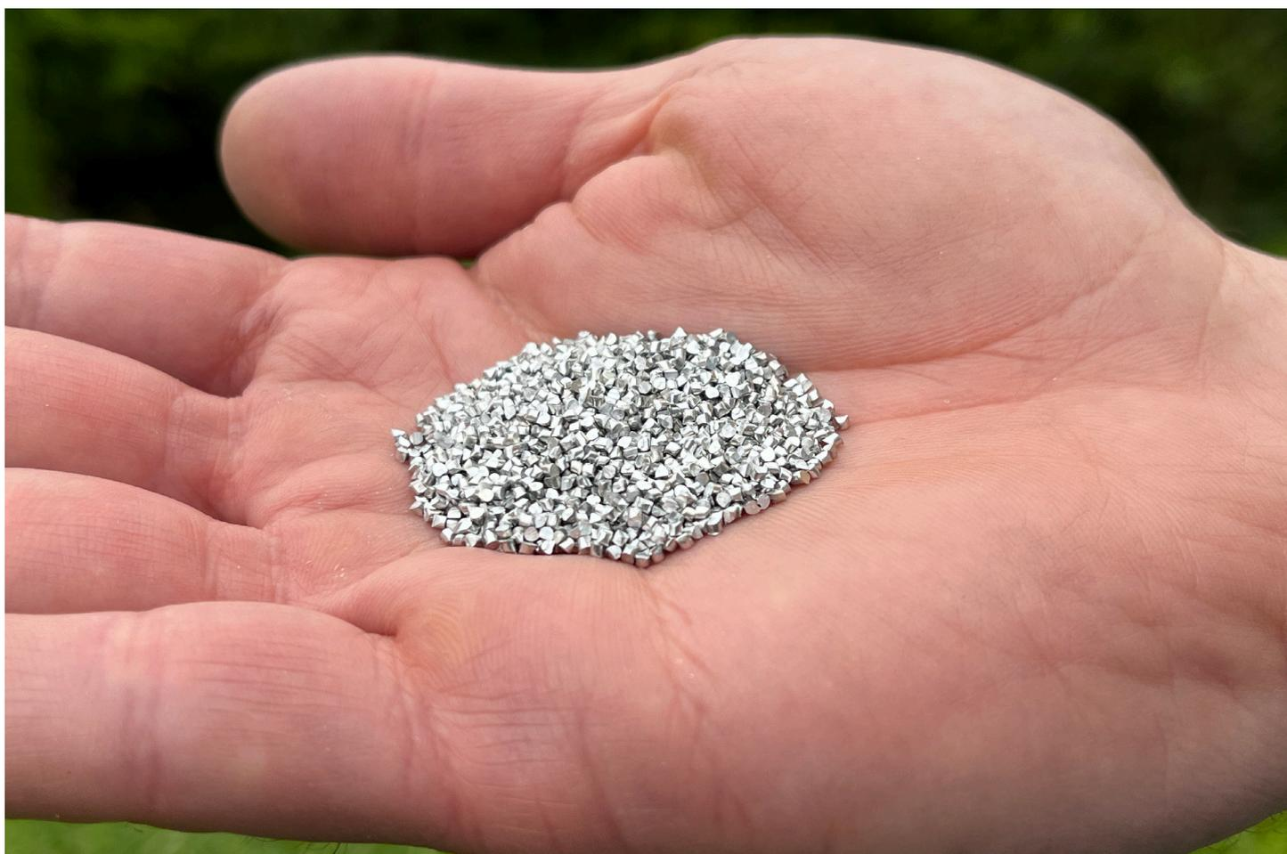
Granulés d'aluminium pour la production de chaleur et d'hydrogène en hiver, avec une densité de stockage d'énergie de plus de 15 MWh par m<sup>3</sup> de matériaux en vrac. Photo: jebe-arts.ch
