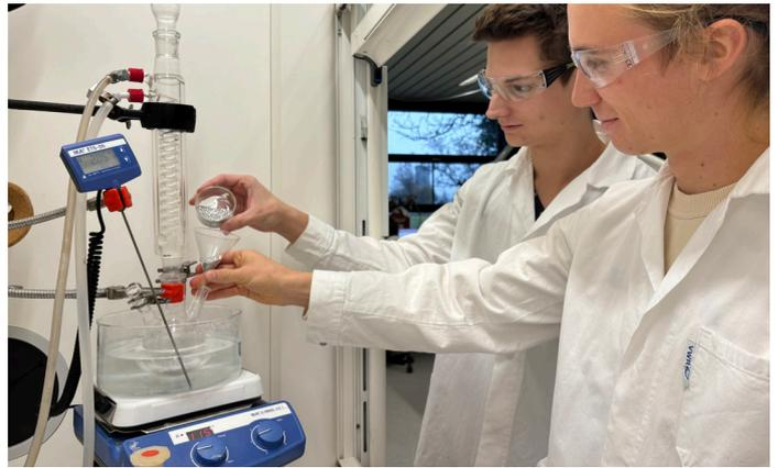
Dans le cadre de travaux de semestre et de diplôme, les étudiants de l'OST déterminent la réactivité des granules d'aluminium et l'hydrogène qui en résulte. Photo : OST-UMTEC
