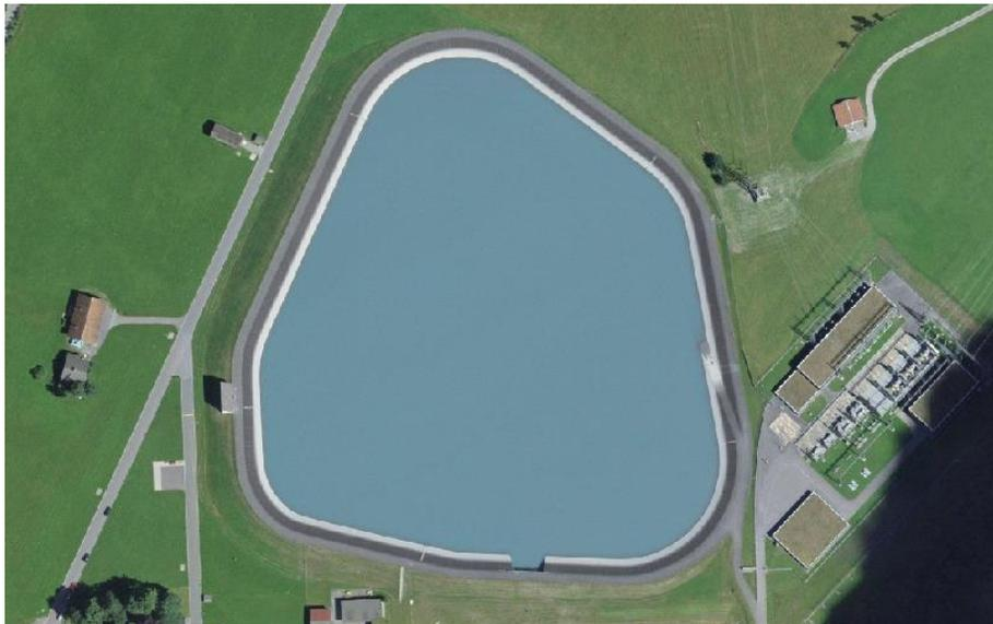
Figure 9 : Le plus grand lac assimilé à un bassin de restitution (48'000m<sup>2</sup>). Ces lacs ont été retirés du potentiel technique en raison des contraintes d'exploitation.
