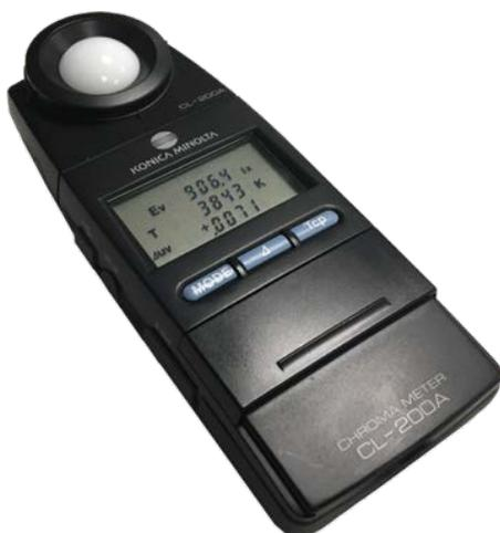
Figure 6 : Appareil de mesure de l'éclairement de Minolta
