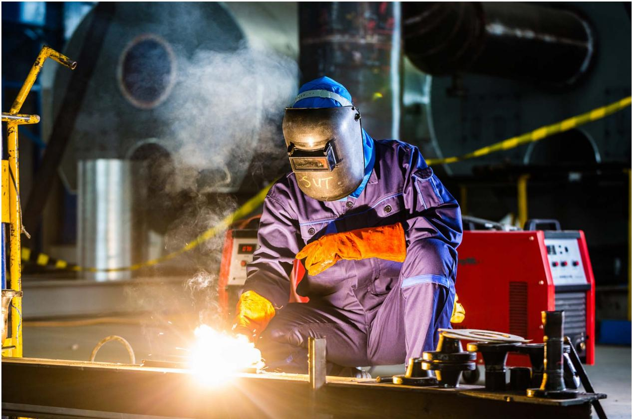
qui peut provoquer un incendie. Il est possible d'éviter ce risque en fixant un certain écart au-delà duquel l'arc électrique ne se forme plus, le déroulement du fil cesse et la fourniture de gaz de protection s'arrête. L'autre avantage d'un tel réglage est d'éviter la perte inutile de gaz et de matériaux d'apport.
