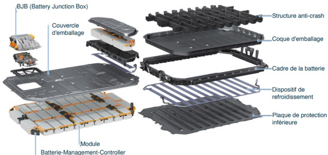
Figure 3: Structure d'une batterie dans son ensemble (RWTH Aachen, 2022b).
