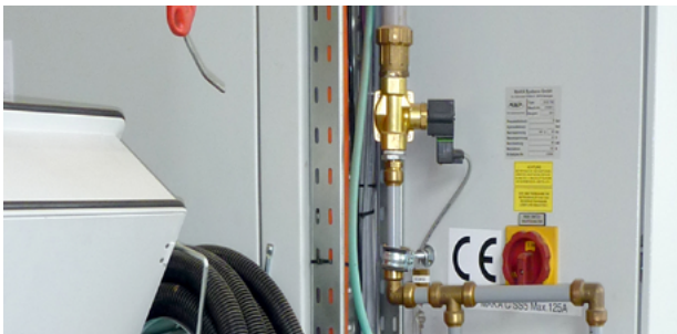
Une électrovanne déconnecte automatiquement la machine du réseau d'air comprimé.
