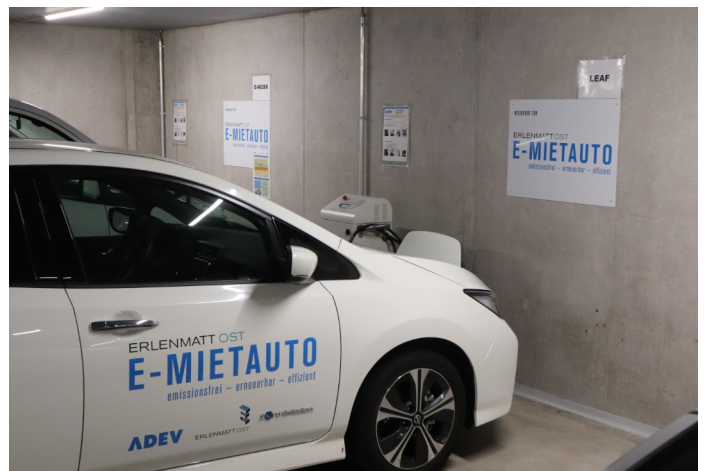
Les batteries de la Nissan E-NV200 Evalia et de la Nissan Leaf peuvent stocker temporairement de l'énergie solaire. La plage comprise entre 30 et 90% de charge peut être utilisée à cette fin. Photo: B. Vogel
