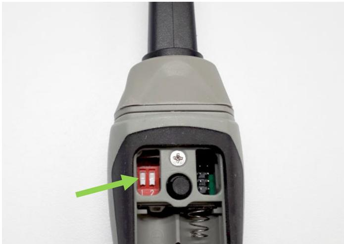
Fig. 10 : curseur pour désactiver la fonction marche/arrêt (flèche verte) sur l'instrument de mesure de Testo.
