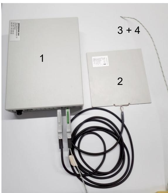
Fig. 4 : instrument de mesure d'Ahlhorn : 1 = enregistreur de données, 2 = plaque de flux thermique, 3 = sonde température intérieure,  $\theta_i$ , 4 = il faut connecter au moins encore une sonde pour la température extérieure,  $\theta_e$ , (même aspect, non illustré).
