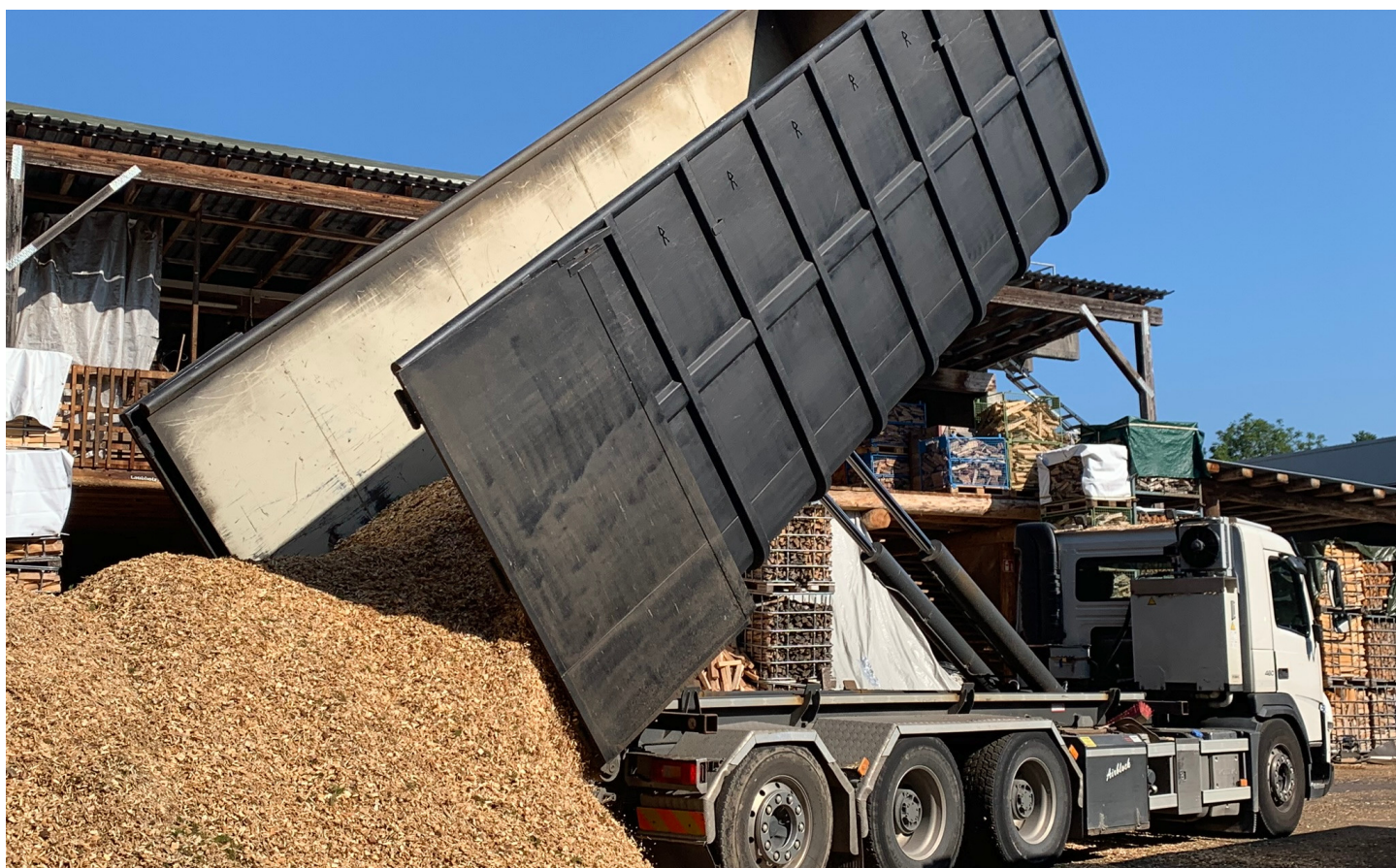
Benne d'une capacité de 45 m 3 , telle que celles utilisées par les entrepreneurs forestiers. Photo: WSL
