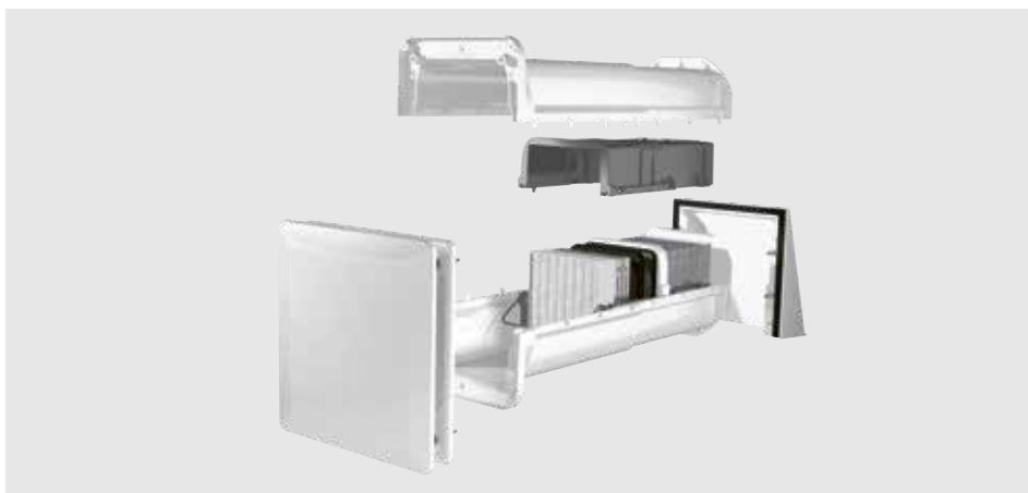
Figure 8.4: Les appareils à flux d'air réversibles pulsent et extraient de l'air de manière alternée. Ils filtrent la poussière et certains modèles récupèrent également de la chaleur et de l'humidité. (Source: Stiebel Eltron)
