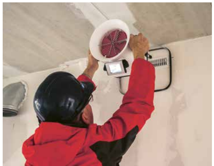
Figure 12.1: Appareil de mesure de débits avec compensation de pression nulle. (Source: ACIN instrumenten bv, BG Rijswijk NL)
