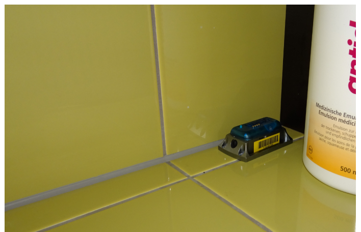
Les chercheurs ont utilisé ces enregistreurs pour mesurer en continu la température et l'humidité de l'air, par exemple dans les salles de bains. Photo: FHNW/HSLU
