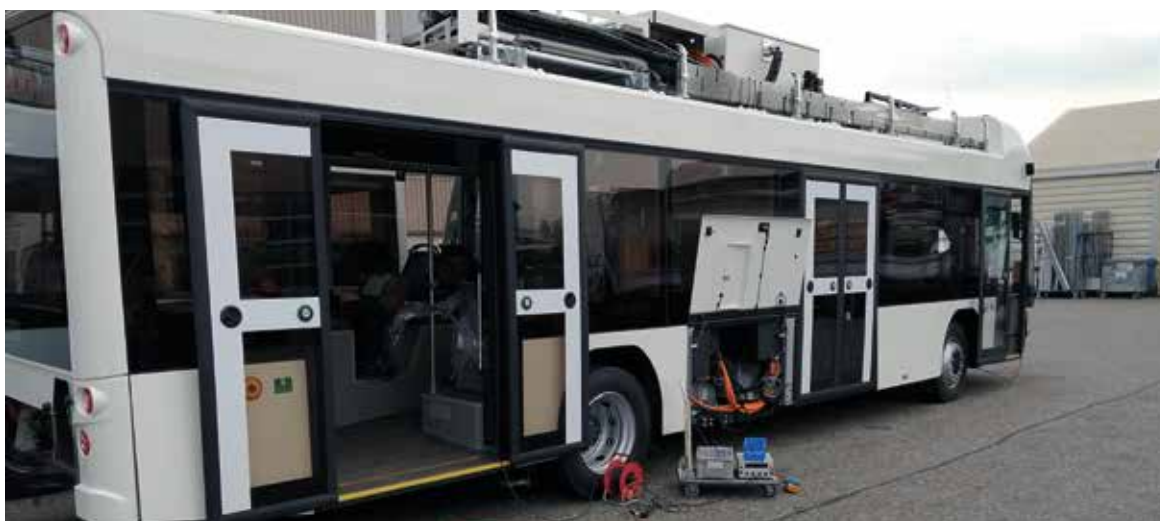
Le groupe motopropulseur et le système de stockage de l'énergie constituent des éléments de coût importants pour les autobus et les véhicules commerciaux à propulsion électrique. Dans le cadre d'un projet pilote, une flotte de bus électriques à batterie sera équipée d'un nouveau convertisseur de puissance basé sur des semi-conducteurs en carbure de silicium (SiC), qui sera intégré directement dans le moteur. L'efficacité du convertisseur de puissance a une influence directe sur la capacité requise de la batterie et donc indirectement sur les coûts du système (source: ABB).
