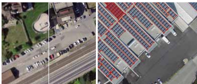
Une condition indispensable à la détection des installations solaires sur les photographies aériennes est une résolution élevée. L'Office fédéral de topographie swisstopo offre désormais des images d'une résolution de 10 cm. L'image à l'extrême gauche illustre par rapport à la résolution précédente de 25 cm (partie gauche de l'image). Afin d'entraîner le réseau neuronal, un total de 7839 images ont été préparées où les installations photovoltaïques et thermiques étaient marquées par des polygones (source: FHNW).
