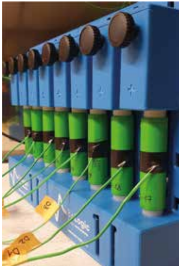
Dans le cadre d'un projet de recherche OFEN, des protocoles de test ont été mis au point qui permettent de déterminer l'état de vieillissement des cellules de batterie en quelques minutes, alors qu'un cycle complet de décharge/charge nécessite de trois à cinq heures (source: CSEM).
