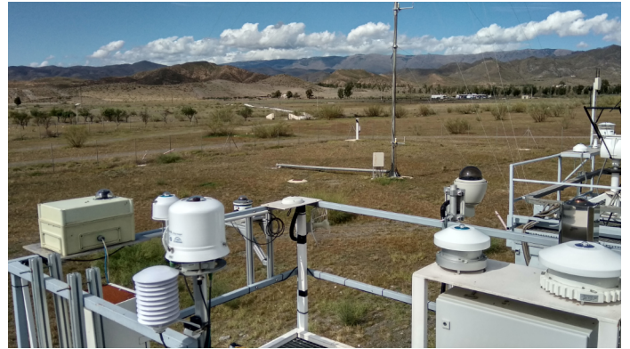
Site d'essai météorologique à Almería (sud de l'Espagne): en été 2020, six logiciels de caméra, dont deux de Suisse, ont été comparés. Photo: S. Wilbert (DLR)..
