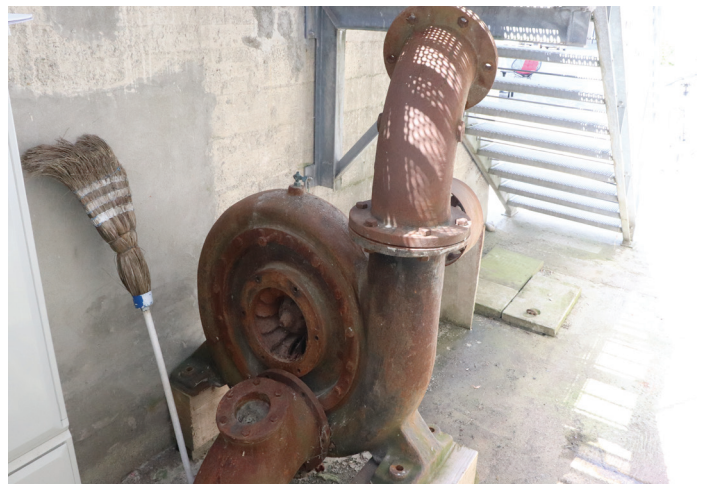
Cette turbine Francis actionnait un moulin à grains dans le moulin Obermühle à Andelfingen de 1941 à 1972. Aujourd'hui, le même type de turbine est utilisé pour produire de l'électricité, la turbine Francis étant construite d'une nouvelle manière à partir d'une pompe à laquelle est ajouté un distributeur. Photo: B. Vogel
