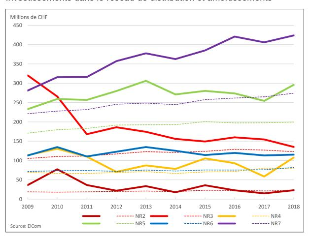
**Figure 17** Investissements (en gras) et amortissements (en traitillé) pour les niveaux de réseau 2 à 7 (en millions de CHF)
