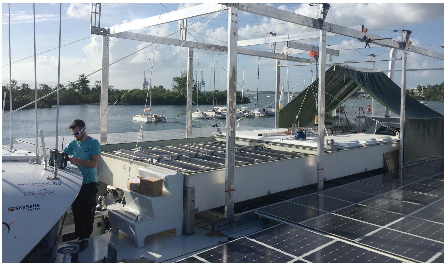
Vue du pont du catamaran à énergie renouvelables : l'énergie solaire produite à bord peut être temporairement stockée dans un système de stockage d'énergie à base d'hydrogène. Photo: Swiss Hydrogen
