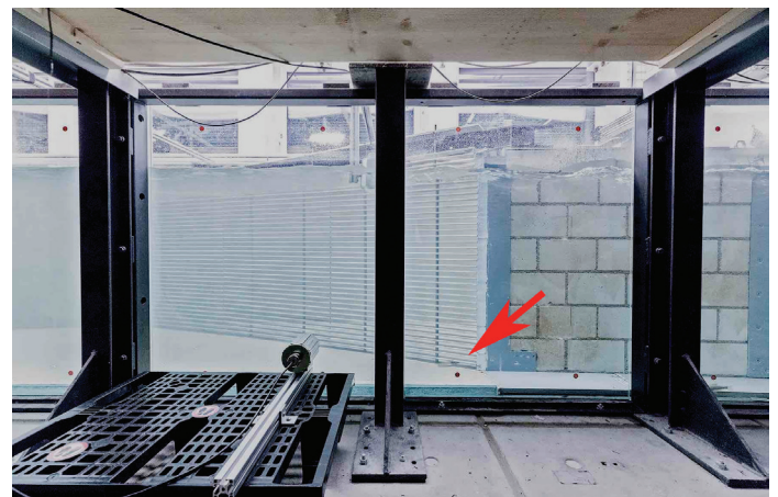
Une caméra saisit le comportement des poissons au niveau de la grille de guidage dans le laboratoire VAW de l'ETH de Zurich. En bas à droite de la grille (flèche) se trouve un barbeau qui nage à contre-courant dans l'eau qui arrive de la gauche et qui risque de passer à travers les barres horizontales de la grille. Photo: VAW
