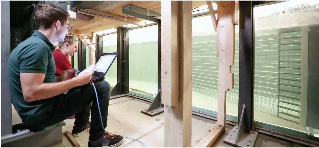
Le doctorant Julian Meister contrôle l'électrification de la grille sur son ordinateur portable et consigne le modèle comportemental particulier des anguilles. La stagiaire Serafin Kattus l'assiste dans cette démarche. Photo: VAW
