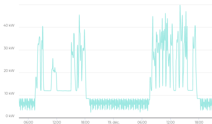
Figure 19 : Monitoring d'une IRM Siemens Lumina 3T (2019) sur deux jours représentatifs
