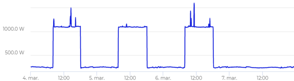
Figure 27 : Monitoring d'un appareil de radiographie sur quelques jours types
