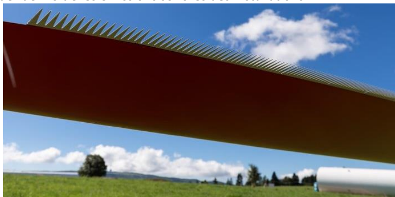
Figure 21 : système de peignes installé sur une pale d'éolienne [Suisse Eole]
