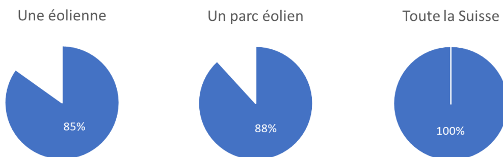
Figure 30 : part temporelle de production d'électricité éolienne (injection sur le réseau) en Suisse en 2018 [Suisse Eole]
