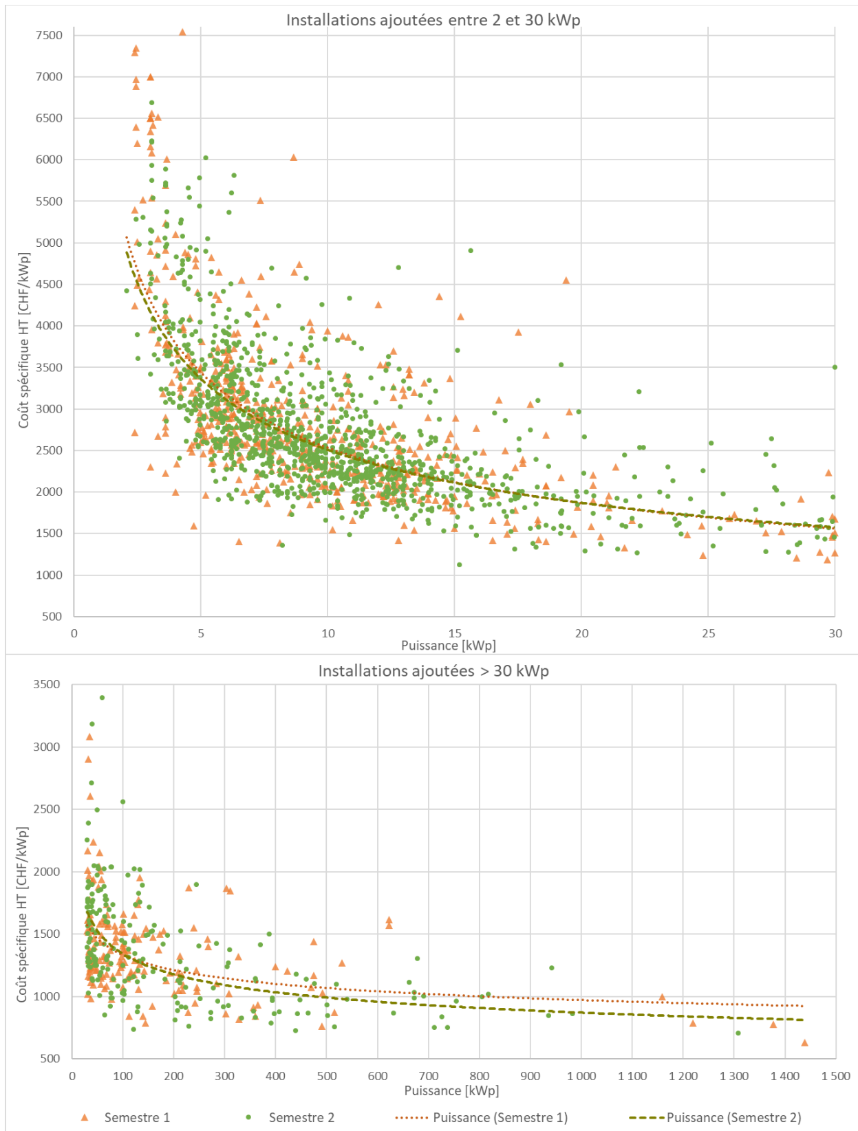
Figure 26 : Evolution entre le semestre 1 et le semestre 2 de 2019 du coût spécifique des installations photovoltaïques ajoutées. A gauche plage de données 2-30kWp, à droite >30 kWp. Les courbes de tendance de type "puissance" ont été obtenues par la fonction "courbe de tendance d'Excel".
