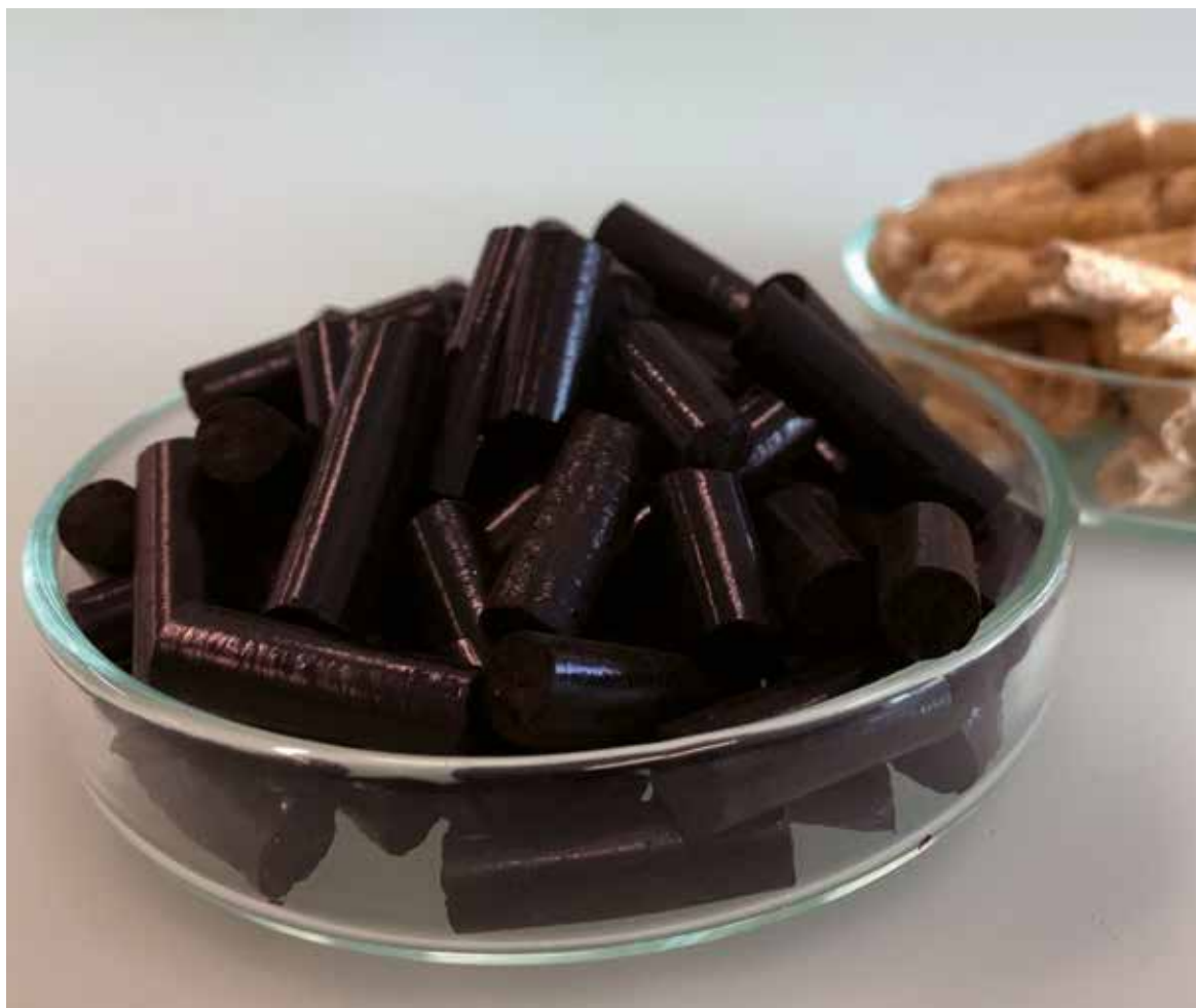
La carbonisation hydrothermale permet la valorisation des matières organiques pour la production d'énergie ou l'utilisation comme nutriments pour les plantes dans l'agriculture de manière écologique, hygiénique et respectueuse du climat. La figure montre le biochar de fumier sous forme de granulés avec une densité énergétique de 10–12 GJ/m 3 (source : FHNW).
