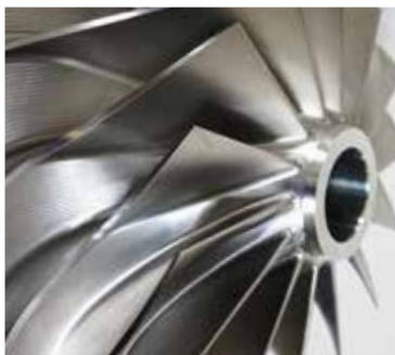
Turbine d'un compresseur d'air à trois étages (source: MAN, Augsburg).
