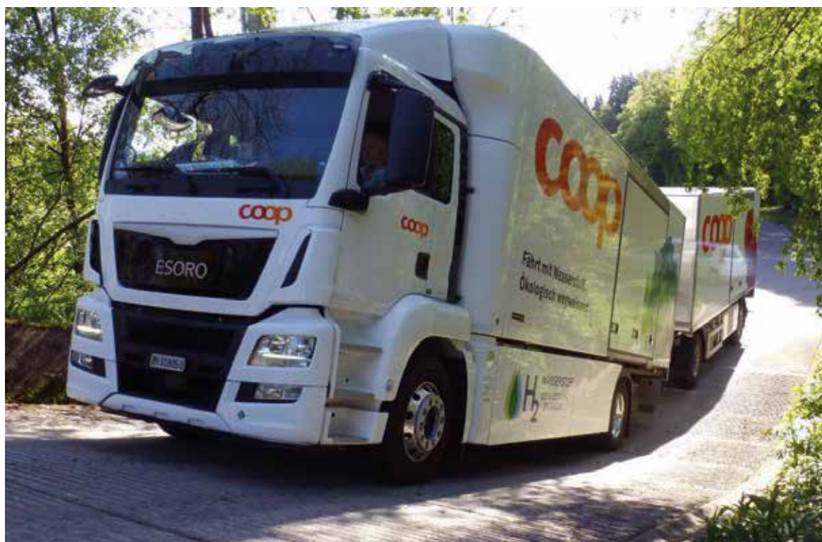
Prototype de camion à pile à combustible développé par Esoro en coopération avec Swiss Hydrogen: Essai de démarrage réussi dans une pente de 30 % et un poids total (camion plus remorque) de 35 tonnes (source: Esoro)
