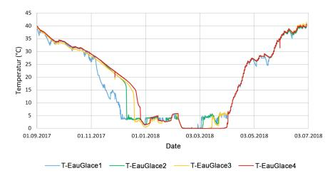
Température dans l'accumulateur de glace au cours de l'année, mesurée à quatre hauteurs différentes. La sonde de mesure 1 se trouve dans le sol, la sonde de mesure 4 en haut, sur la surface de l'eau. Dans la mesure où les échangeurs de chaleur sont installés dans le sol, une stratification des températures a lieu en automne en raison de l'extraction de la chaleur. La plus forte production de glace a eu lieu au début du mois de mars. Graphique: Rapport final de l'OFEN
