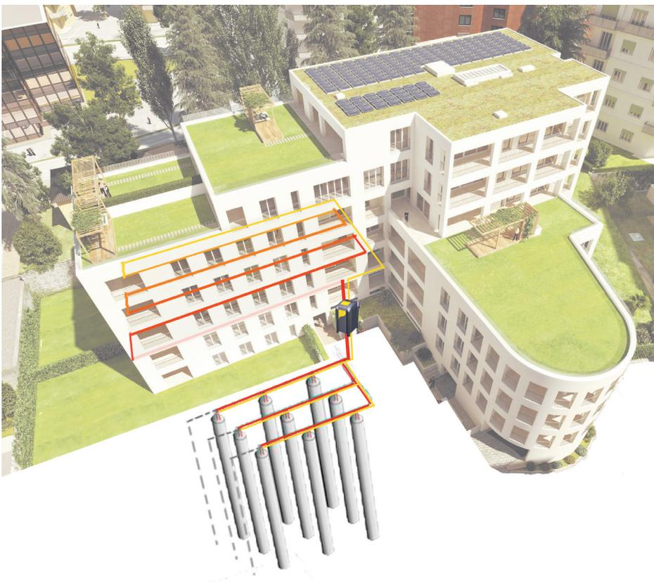
Die Liegenschaft «City Residence» in Lugano mit 46 Apartments. Für Heizung (Winter) und Kühlung (Sommer) des Gebäudes wurden unterhalb des Baus 13 Erdwärmesonden bis auf 200 Meter tief abgesenkt, wo die Erdtemperatur rund 14,5 °C beträgt. Jede Erdwärmesonde besteht aus einem doppelt geführten Rohr, das in das Bohrloch eingeführt wird. Zuletzt wird das Bohrloch mit einer Art Zement (Bentonit) verfüllt. Illustration: SUPSI
