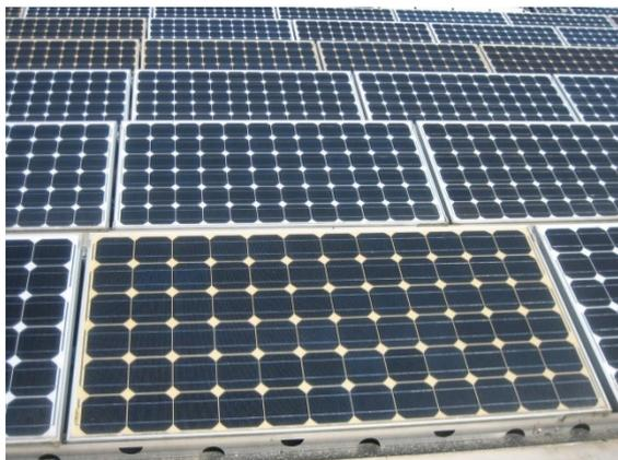
Abbildung 2: Verfärbung der Module (browning), Jendra Power AG\$
