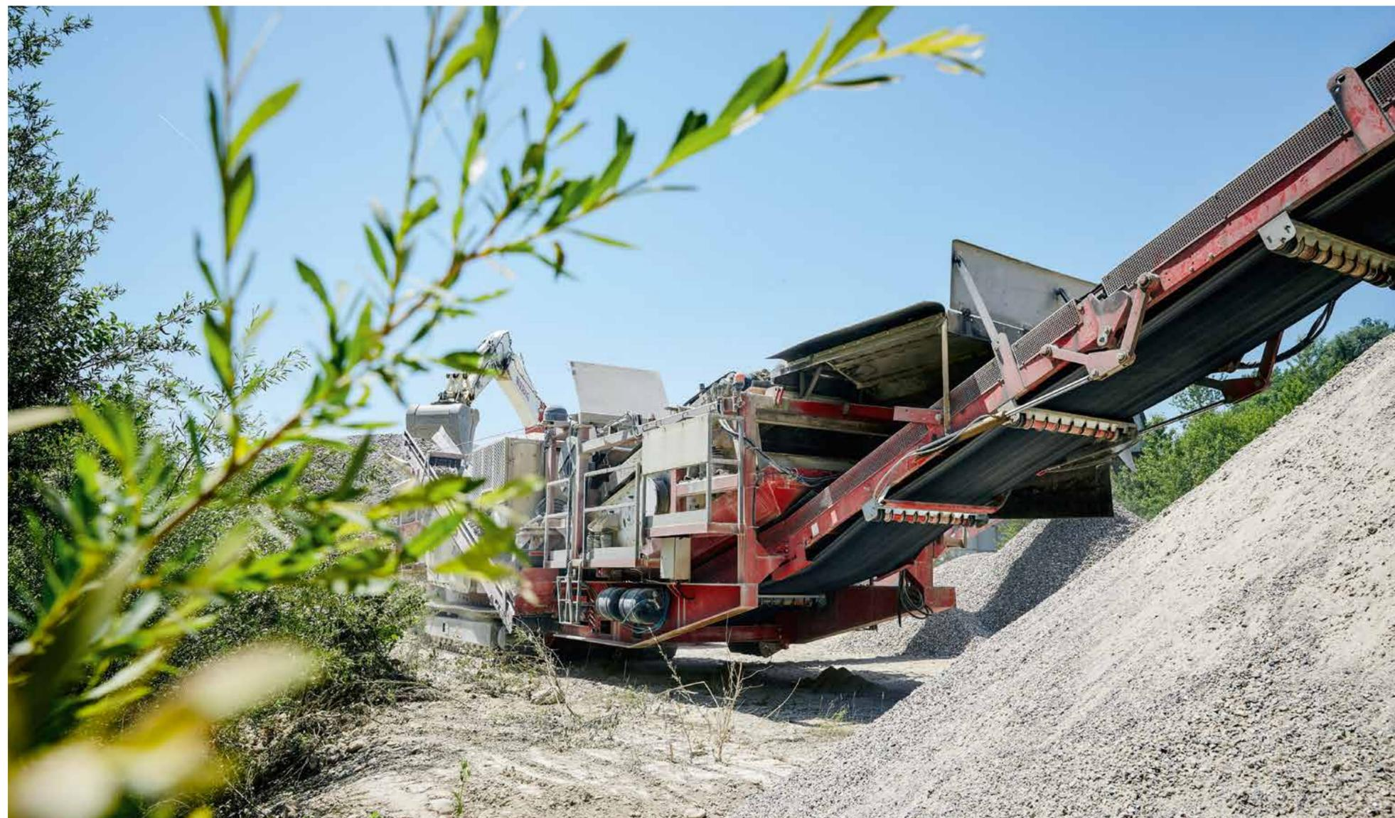
Kieswerk Aebisholz bei Oensingen (SO): Eine mobile Brechanlage zerkleinert Betonteile zu Granulat, dem Grundstoff für Recyclingbeton.
