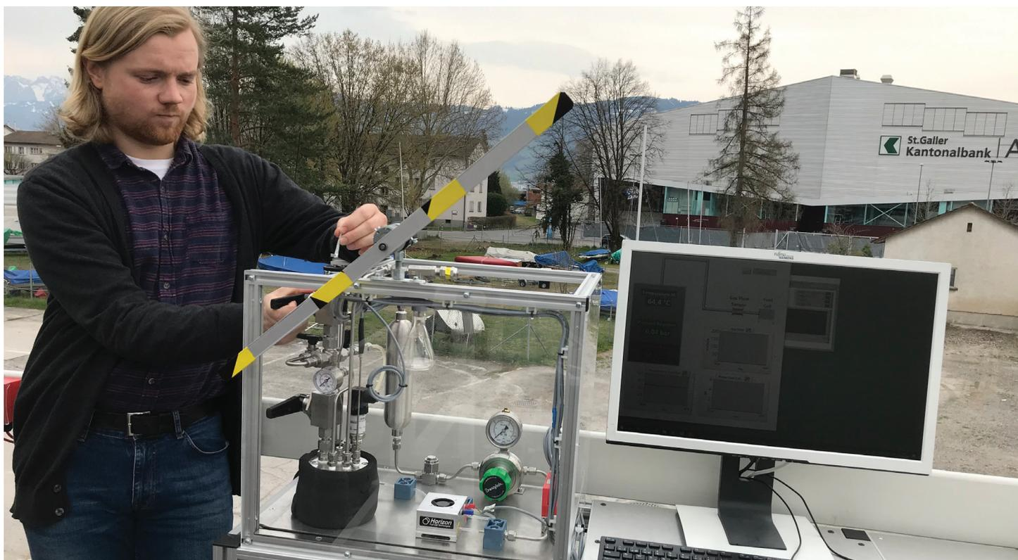
HSR-Forscher Ivo Caduff „füttert“ das Funktionsmuster der Erzeugereinheit für Wärme und Strom mit einem Stück Alufolie. Dieses oxidiert dann im Reaktionsgefäß (schwarz ummantelt) unter Abgabe von Wärme zu Wasserstoff, welcher in einer kleinen Brennstoffzelle (weisse Box) in Strom umgewandelt wird, der den Elektromotor des Propellers antreibt. Das Funktionsmuster hat eine Leistung von  $10 \text{ W}_{el}$ . Foto: B. Vogel
