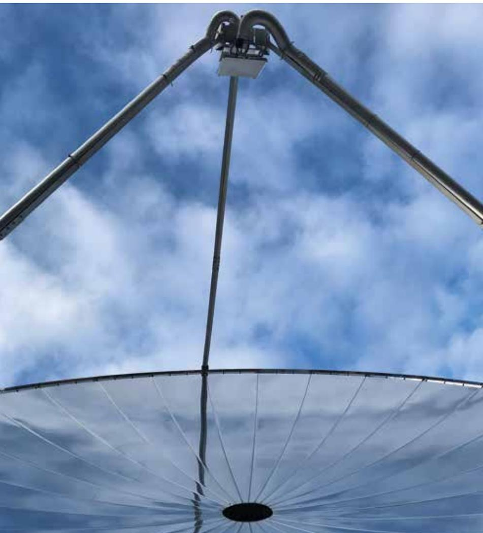
Solarer Konzentrator des Laboratory of Renewable Energy Science and Engineering an der EPFL zur Produktion von erneuerbarem Gas (Wasserstoff). Die Kombination eines photo-electrochemischen System mit konzentrierter Solarenergie zusammen mit einem intelligenten Wärmemanagement erlaubt die Umwandlung von Solarenergie zu Wasserstoff mit Effizienzen bis zu 17 % (siehe S. Tembhurne, F. Nandjou & S. Haussener, Nature Energy 4, 399-407, 2019).
