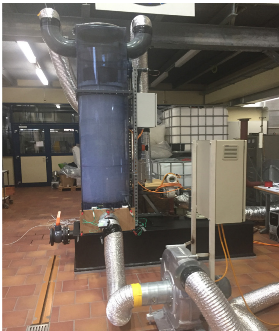
Abbildung 13: Versuchsanlage der ZHAW (2017), mit Absorptionssäule in Blau.
