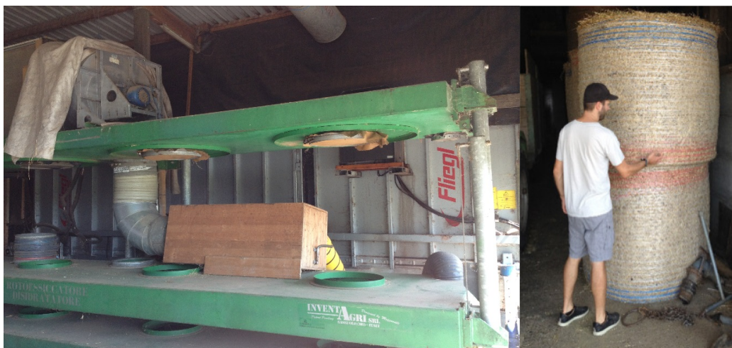
Abbildung 14: Heuballentrocknungsanlage von Inventa (links) auf dem Betrieb Natur Energie und die fertig getrockneten Ökoheu-Rundballen (rechts).
