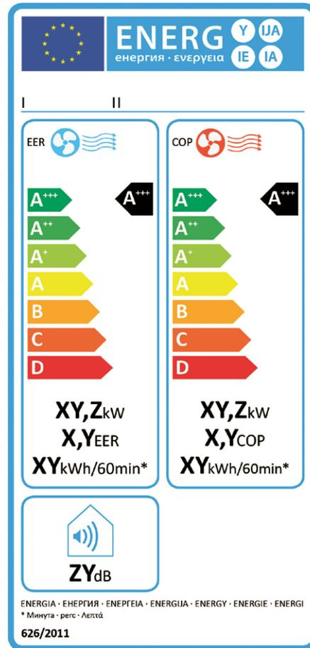
Bild 10.11: Energieetikette netzbetriebene Raumklimageräte. Für die Beurteilung der Effizienz im Kühlbetrieb ist der EER massgebend.
