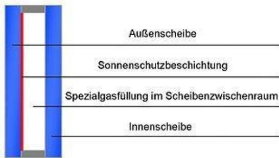
Abbildung 15: Aufbau eines Sonnenschutz-Isolierglases auf Basis Silberbeschichtung (Schweizerischer Fachverband Fenster- und Fassadenbranche, [www.fff.ch](http://www.fff.ch))
