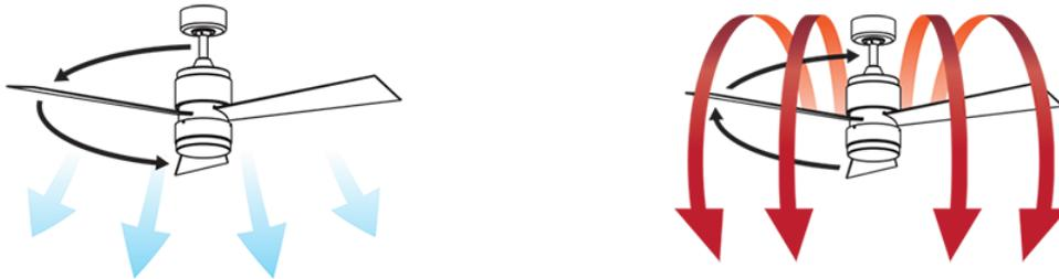
Abbildung 12: Bedienung von Deckenventilatoren in Sommer- und Winter-Modus.
