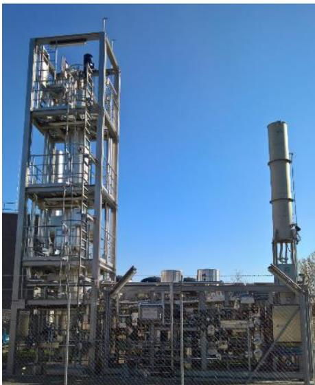
**Abb. 3:** Reaktorturm (links), Gasskid mit Fackel (rechts)
