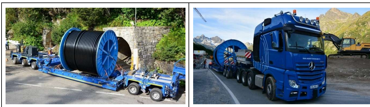
Abbildung 7: Transportfahrzeug mit Kabeltrommel auf Spezialplattform, Achse in Fahrtrichtung transportiert (Quelle: Fa. Wassermann Kabeltechnik)
