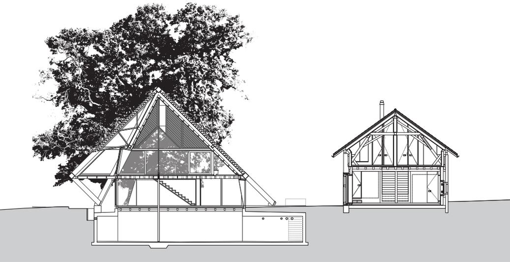
Querschnitt durch Neu- und Altbau.
