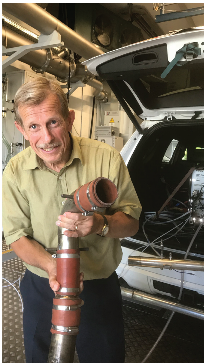
Prof. Jan Czerwinski zeigt auf dem Rollenprüfstand das Rohr, das die Abgase vom Auto zur Messeinrichtung im Nebenraum führt. Foto: B. Vogel
