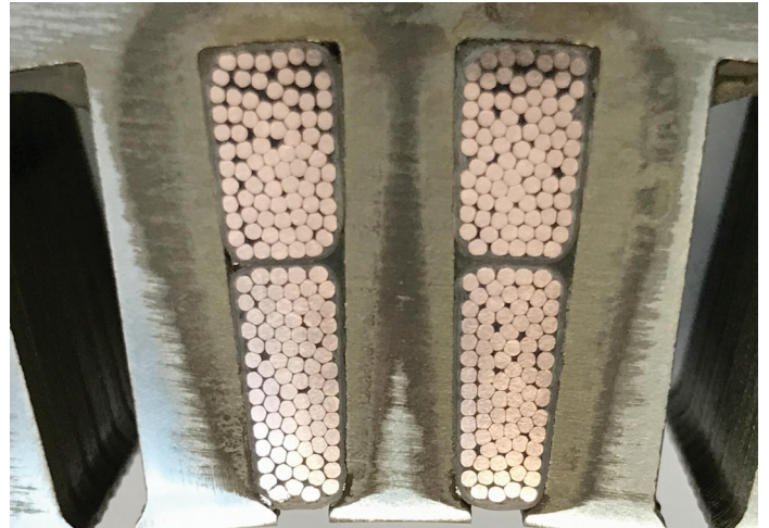
Moderne Formlitzewicklung für den Stator eines Elektromotors, ausgeführt als Einsteckwicklung. Die Wicklung ist ausserordentlich kompakt und erreicht dadurch einen hohen Füllfaktor von 56%. Foto: BRUSA
