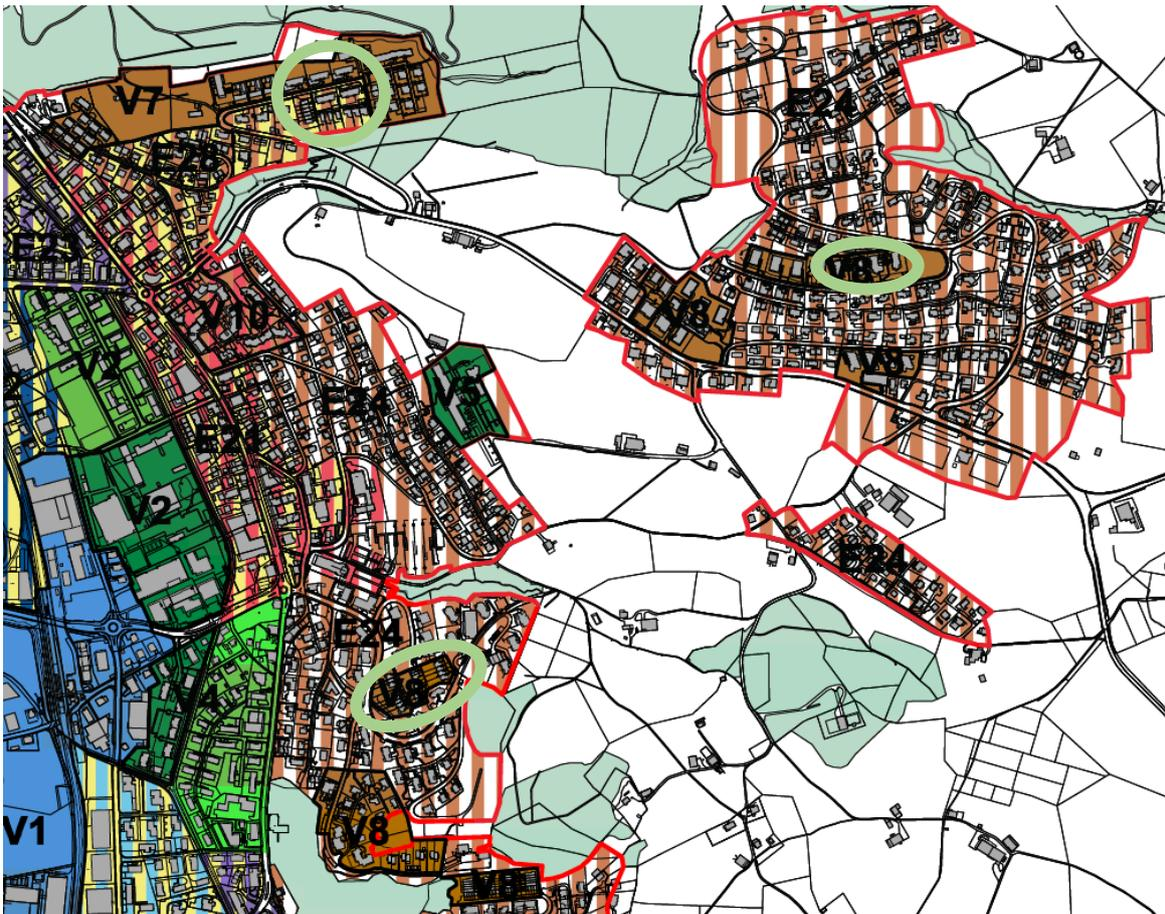
Abbildung 7: Die drei ausgewählten Wärmeverbände für die Untersuchung, V7-Stirnrüti (oben links), V8-Schiltmatthalde (unten), V8-Stegenstrasse (oben rechts). [2]
