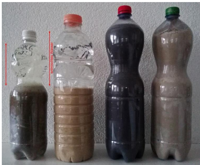
Abb. 19 Unterschiedliches Absetzmass der beprobten Hinterfüllungen
