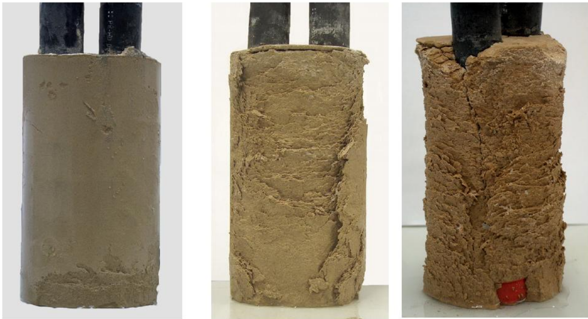
Abb. 6 Fertigmischung nach 0, 2 und 4 Frost-Tau-Wechsel
