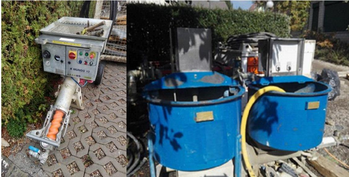
Abbildung 7 Mörtelmischpumpe (links) und Kollodialmischer (rechts)
