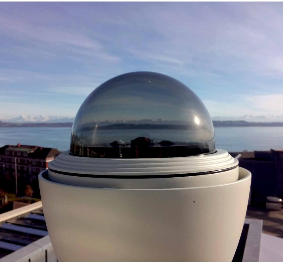
*Das Centre Suisse d'Electronique et de Microtechnique (CSEM) testet das System «Skycam» auf Basis günstiger 360°-Industriekameras, mit dem über Softwarealgorithmen Wolken erkannt werden können und sich deren Bewegung bestimmen lässt. Damit kann die Sonneneinstrahlung direkt lokal bestimmt und über das Verfolgen der aktuellen Wolkenbewegung die Veränderung der Sonneneinstrahlung kurzfristig präzise voraussagesagt werden (Quelle: CSEM).*
