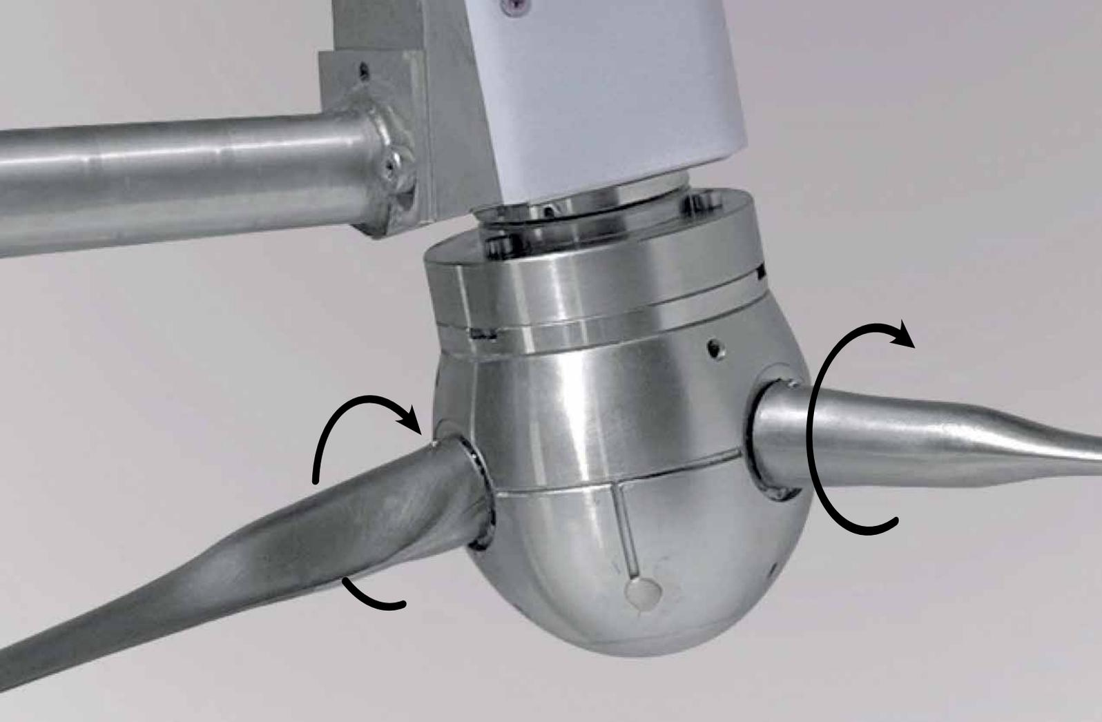
Modell einer Windturbine zur Untersuchung der individuellen Steuerung der Rotorblätter (Quelle: ETH Zürich).
