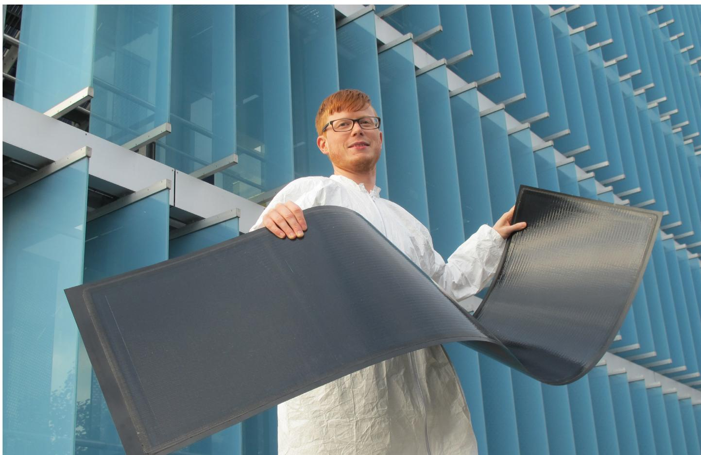
CIGS-Module bestehen aus einer Kunststoffolie (Polymer), die in mehreren Prozessschritten mit photoaktiven Materialien beschichtet wird.
