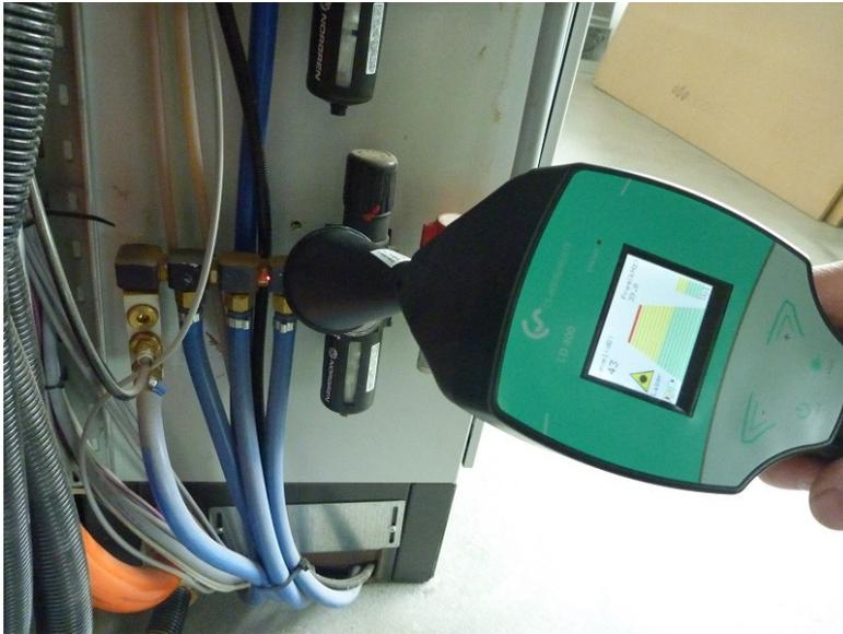
Foto 3: Lecksuche am Druckluftanschluss des Bearbeitungszentrums
