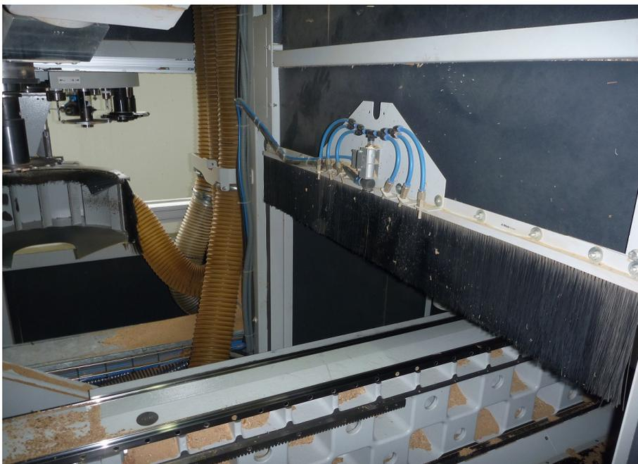
Foto 2: Die 6 Abblasdüsen der Fräsmaschine
