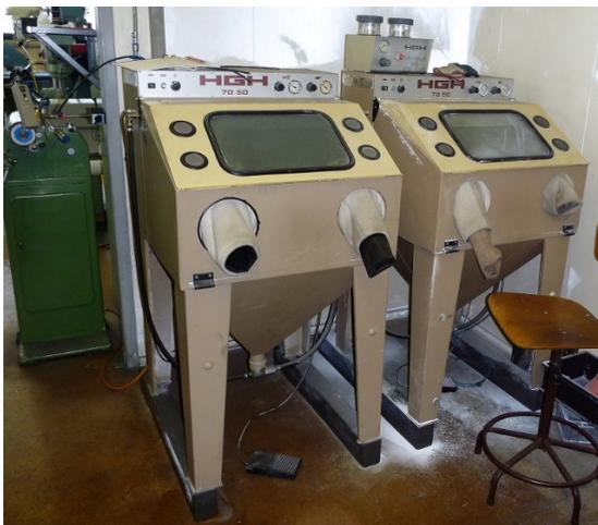
Foto 19: Zwei Sandstrahlanlagen mit wenig Betriebsstunden.
