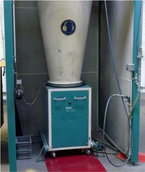
Foto 6: Pulverrückgewinnung unter Zyklon.
