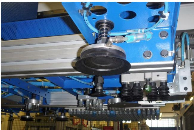
Foto 2: Pneumatisch betriebene Saugheber (Total 46 Stück) für die Zufuhr von Blechtafeln.
