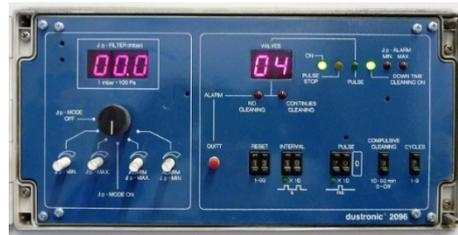
Foto 8: Steuerung für Filterabreinigung.
