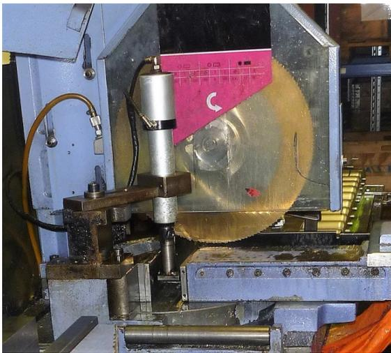
Foto 17: Pneumatische Spannvorrichtung.
