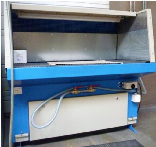
Foto 21: Pneumatisch betriebene Absaugbox für Einzelteile mit nur wenig Betriebsstunden pro Jahr.
