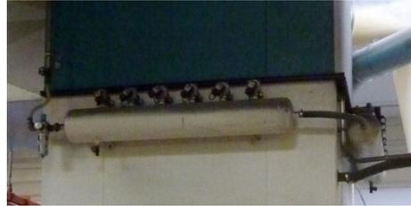
Foto 7: 12 Ventile für Abreinigung Absolutfilter.
