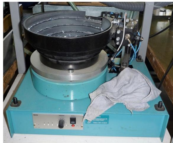
Foto 20: Sortiermaschine mit hörbarer Leckstelle.
