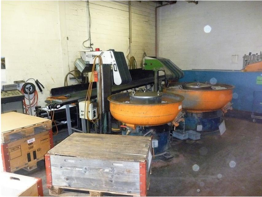
Foto 11: Trowalisieranlage mit dahinterliegenden Membranpumpe.
