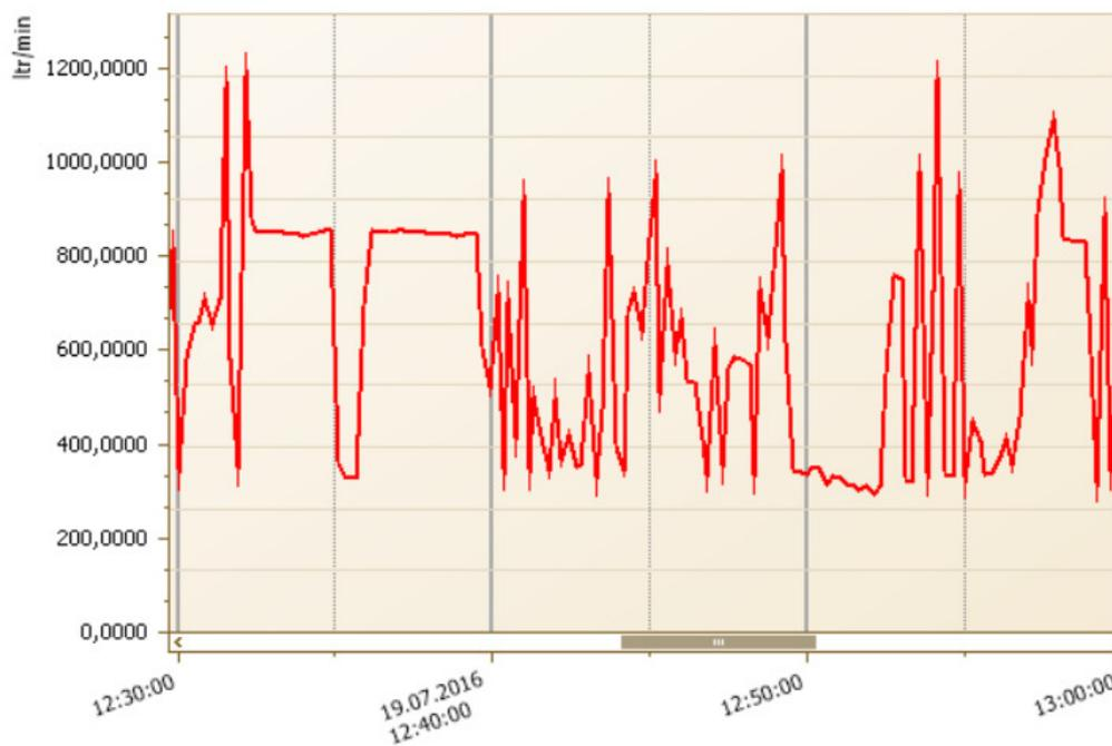
Abbildung 2: Luftverbrauch in ltr/min der Laserstanzmaschine über 30 Minuten. Durchflussmessgerät CS Instrument VA520 mit 1 Zoll Messrohr. Zeitauflösung 10 Sekunden.
