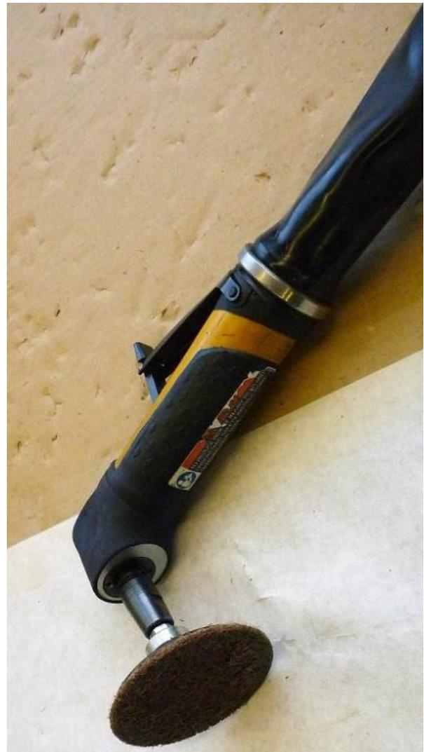
Foto 26: Pneumatische Schleifmaschine.
