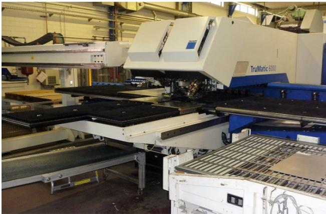
Foto 1: Laserstanzmaschine.
