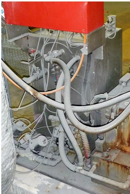
Foto 13: Membranpumpe hinter der Zentrifuge.
