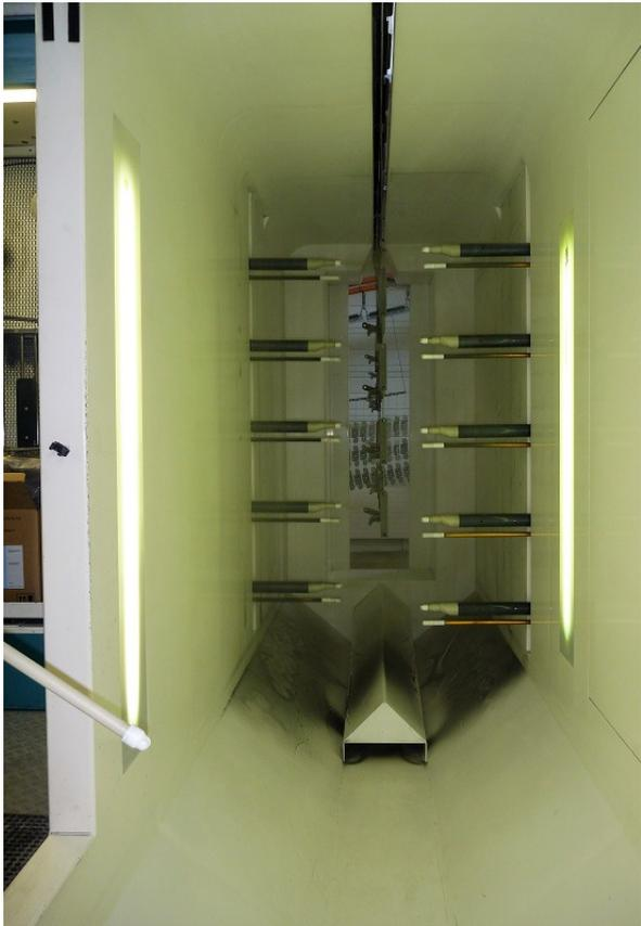
Foto 4: Pulverlackierkabine mit 2 mal 10 Automatikpistolen
